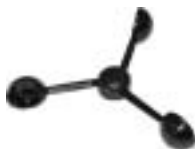
Anemómetro da unidade do cabeçote do mastro
