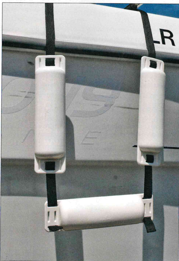
Les défenses peuvent être fixées à l'horizontale ou à la verticale. Seule précaution : sécuriser la défense du bas pour éviter qu'elle quitte la sangle.
