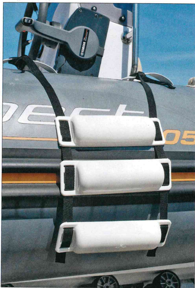
Le système développé par Plastimo consiste à assembler trois défenses à l'aide d'une sangle, le tout épousant la forme courbe d'un flotteur.
